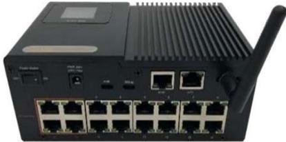
S-IoT Box 는 산업용 IoT 환경에서 다양한 센서 및 장비와 연결할 수 있는 고성능 IoT 게이트웨이입니다. Wi-Fi 및 Ethernet 네트워크 지원을 통해 안정적인 데이터 통신이 가능합니다.
